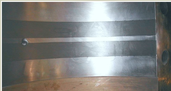
Depois - Acabamento com precisão milesimal, moldado sem uso de usinagem
