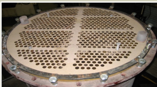
Antes - Com desgaste e mistura água/óleo
