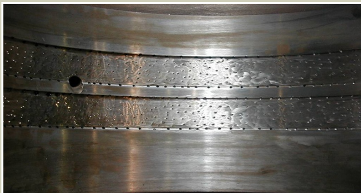
Antes - Desgaste provocado pelo rolamento
