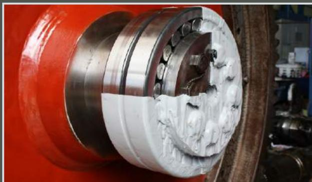
OXIFREE é um revestimento de resina polimérica para a proteção contra corrosão e uma excelente barreira contra a contaminação de particulados. Contém inibidores de corrosão orgânicos, e fornece proteção contra todos os contaminantes corrosivos, com a vantagem de prover fácil remoção (sem aderência à superfície) e ser reutilizável. Além disso contém menos de 0,5% de compostos orgânicos voláteis (VOCs), portanto, não tem impacto ecológico ou ambiental adverso.
