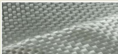
Os materiais compostos são combinações de dois materiais com propriedades físicas e mecânicas totalmente distintas (resina + fibras), que quando utilizadas em conjunto apresentam propriedades mecânicas elevadas.
