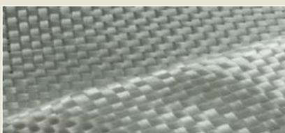
Os materiais compósitos são combinações de dois materiais com propriedades físicas e mecânicas totalmente distintas (resina + fibras), que quando utilizadas em conjunto apresentam propriedades mecânicas elevadas.
